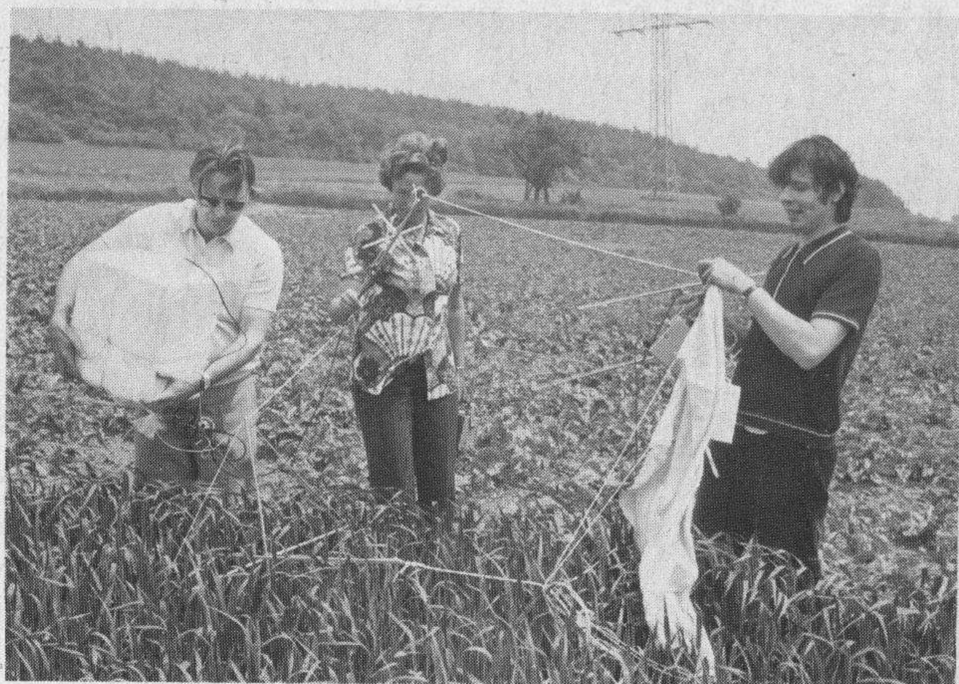
Bild 2: Bergung des Transponders, der zum Kälteschutz in Styropor verpackt war (links), und des Fallschirms (rechts) nach dem ARTOB-Flug (Foto: Schoening).
